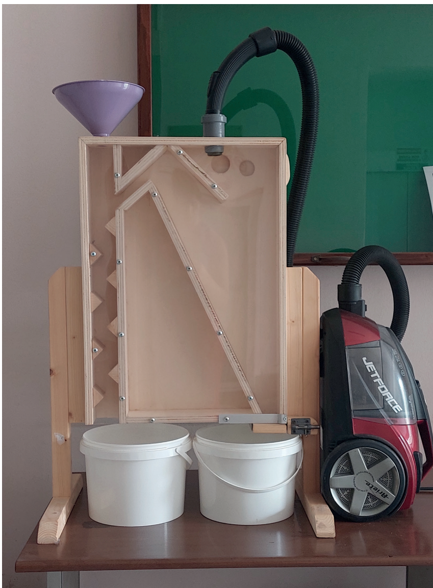
Foto 1 – Separatore di semi pieni e semi vuoti di canapa messo a punto presso l'Università di Catania secondo le indicazioni della letteratura.
