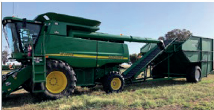
Figura 4 - Sistema 'Chaff Cart' dell'azienda Springfield (Australia) per il recupero del residuo di trebbiatura del frumento tramite un nastro trasportatore posizionato sotto il carter della mietitrebbia che raccoglie i residui che fuoriescono dai crivelli superiori, trasportandoli all'interno di un cassone trainato; è possibile raccogliere tutto il materiale che fuoriesce dalla parte posteriore della mietitrebbia o spargere la paglia e raccogliere semplicemente la pula proveniente dai setacci (Pari et al., 2019)
