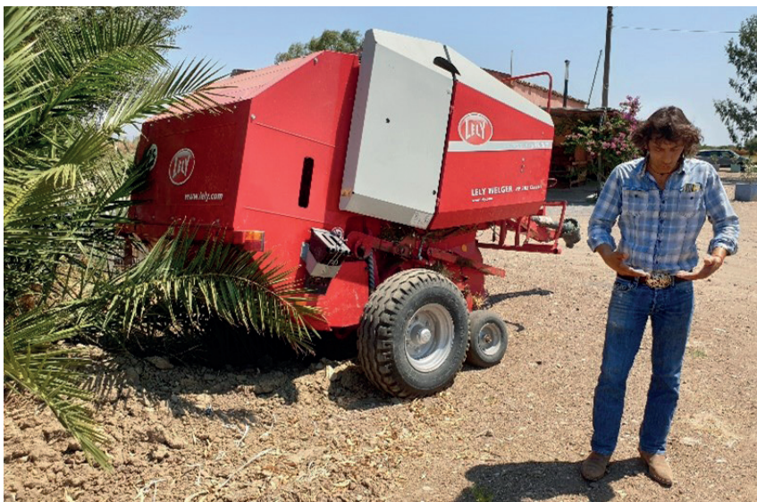
Figura 6 - Rotopressa per la raccolta dei fusti di canapa presso l'azienda agricola Agrobiofert, Ramacca (CT)
