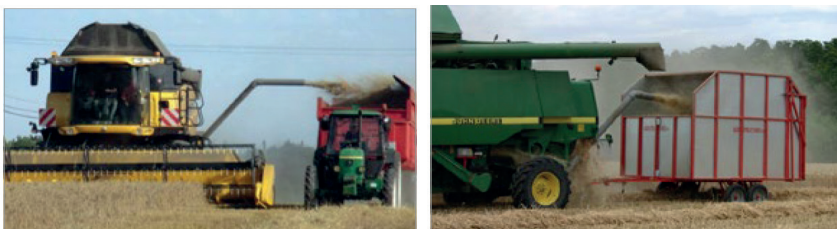
Figura 3 - Sistema Thievin (Francia) per il recupero del residuo di trebbiatura del frumento (pula) con scarico su cassone trainato da un trattore (a sinistra) o dalla stessa mietitrebbia (a destra) (Pari et al., 2019)
